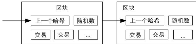
工作量证明同时解决了在多数决定中确定投票方式的问题。如果多数是按 IP 地址投票来决定，那么它将可能被能分配大量 IP 地址的人破坏。工作量证明本质上是按 CPU 投票。最长的链代表了多数决定，因为有最大的计算工作量证明的精力投入到这条链上。如果多数的 CPU 算力被诚实节点控制，诚实的链就会增长得最快并超过其他竞争链。要修改过去的某区块，攻击者必须重做这个区块以及其后的所有区块的工作量证明从而赶上并超过诚实节点的工作。我们后面会证明随着后续的区块被添加一个更慢的攻击者赶上诚实节点的概率将呈指数级递减。
